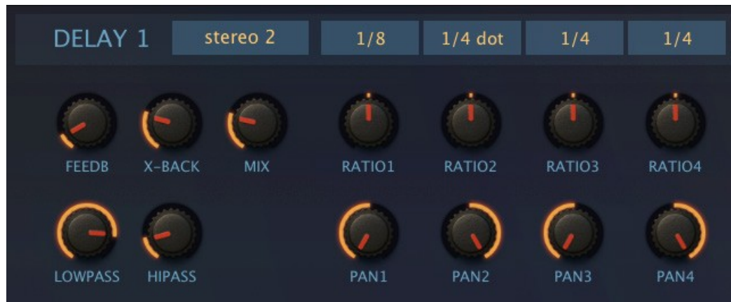
Delay-Modul im Stereo-2-Modus (Ping-Pong-Regeneration über x-back)
