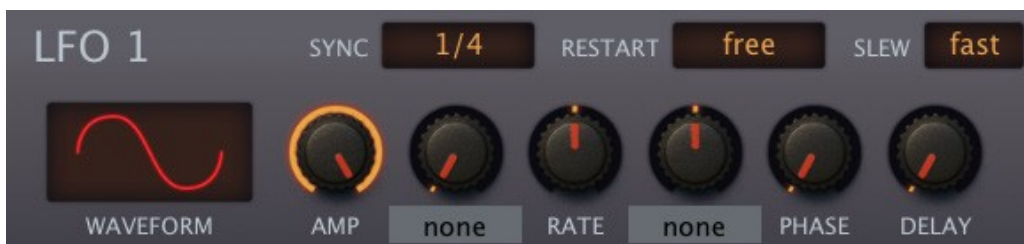
Die Frequenz ist hier host-synchronisiert, aber die RESTART-Phase ist zufällig
